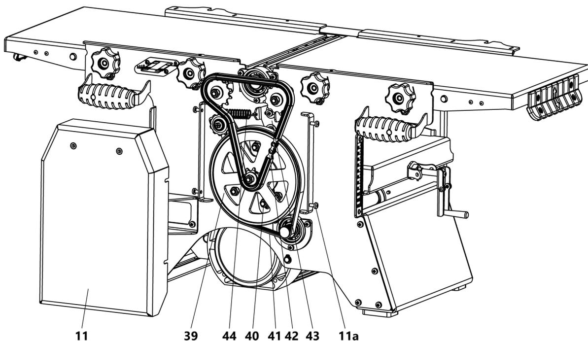
**Рис. 16** Установка ремня и цепи автоматической подачи при рейсмусовании
