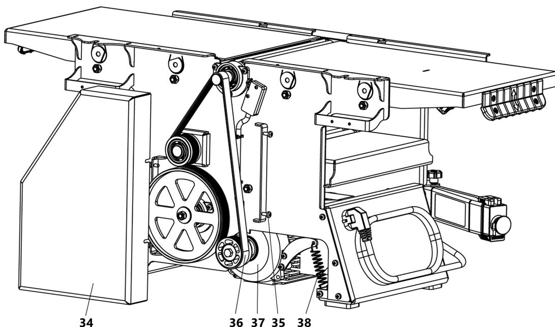
**Рис. 15** Установка приводного ремня
