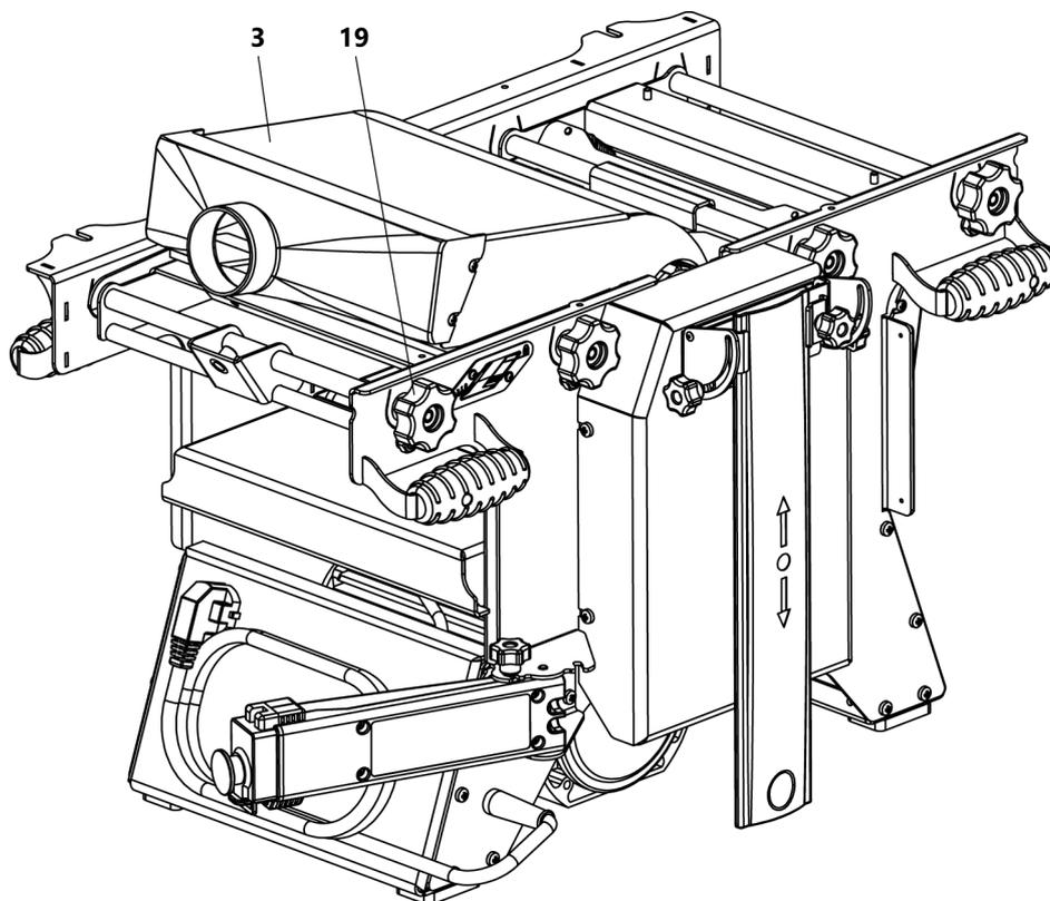
**Рис. 7** Установка кожуха для удаления стружки при рейсмусовании
