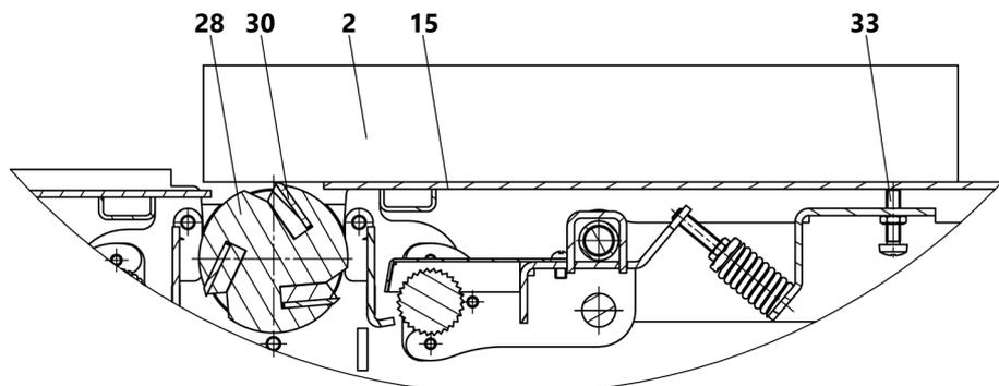
**Рис. 13** Настройка приемного стола относительно кромки строгального ножа
