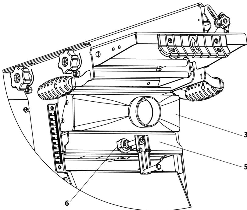
**Рис. 5** Установка кожуха для удаления стружки при строгании
