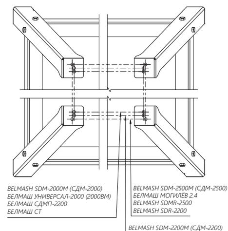
Рис. 3 Присоединительные отверстия подставки (вид сверху)
